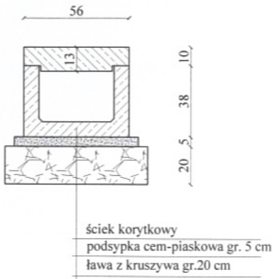
ŚCIEK KORYTKOWY NA ZJAZDACH
